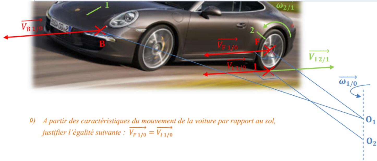
9) A partir des caractéristiques du mouvement de la voiture par rapport au sol, justifier l'égalité suivante :  $\vec{V}_{F1/0} = \vec{V}_{I1/0}$
