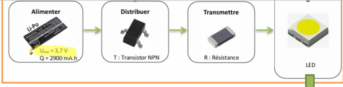
Note : le transistor T sera considéré comme parfait, il ne s'opposera pas au passage du courant il ne provoquera donc pas de chute de tension à ses bornes.
